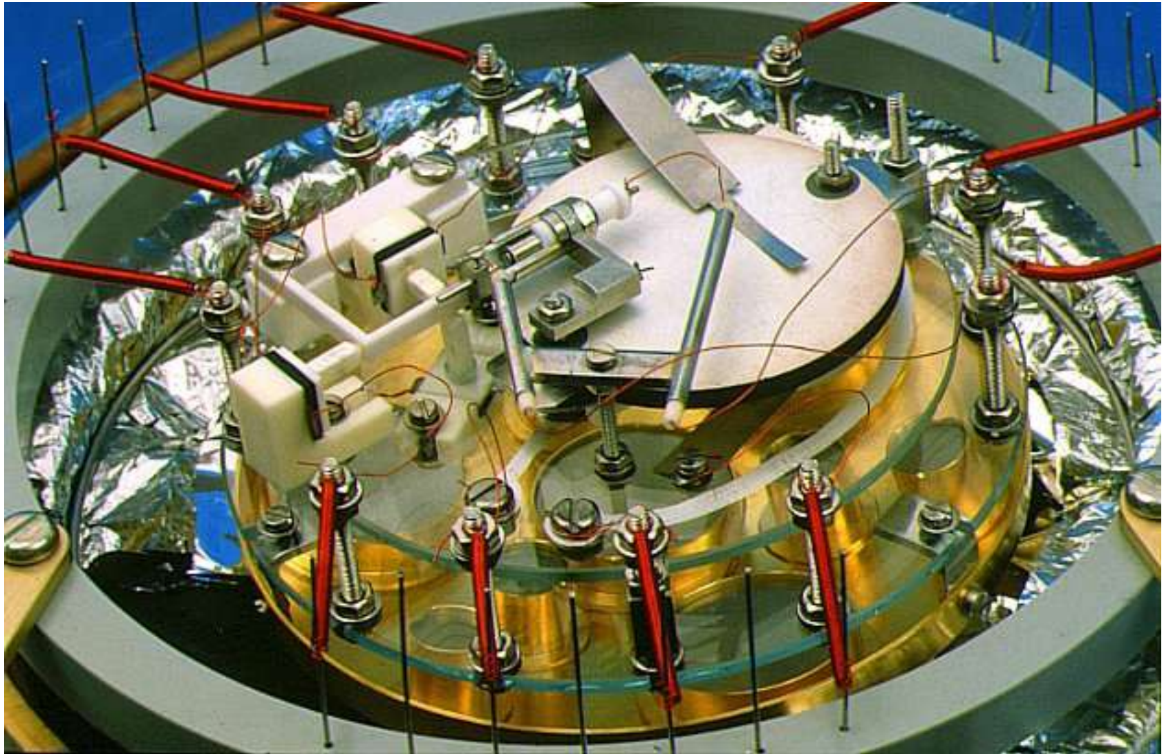
Rastertunnelmikroskop Binnig/Rohrer (Nachbau)
