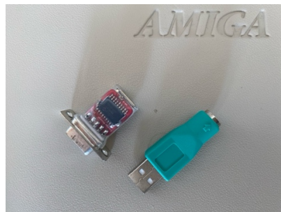
9 Pin Mausadapter mit USB Anschluss. Rechts seht ihr ein USB zu PS/2 Adapter.
